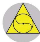
La couleur jaune indique que le poteau est relié au réseau d'eau sur-pressé. La mise en œuvre de ce type de poteau nécessite des précautions particulières.
