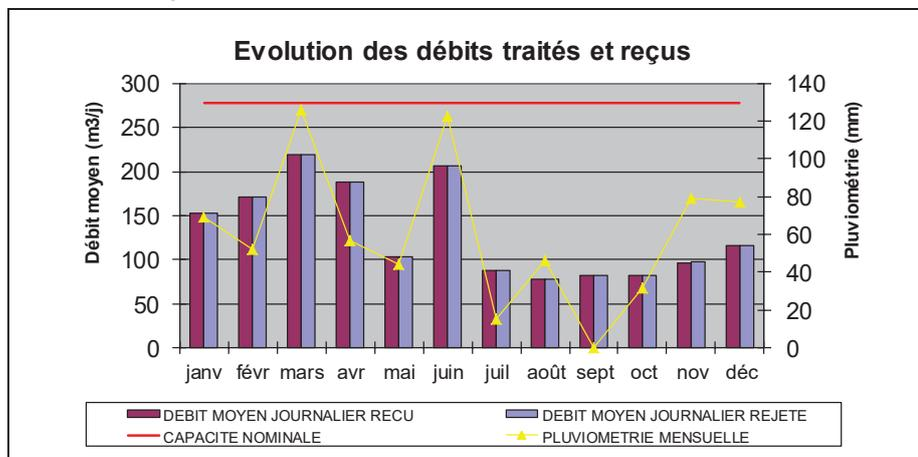
La charge reçue traduit un respect global des capacités nominales. L'incidence de la pluviométrie met en évidence une sensibilité du réseau de collecte aux intrusions d'eaux parasites. Cette sensibilité s'exprime en particulier à la faveur d'épisodes pluvieux de forte intensité (orage). Le débit de rejet autorisé est respecté.
