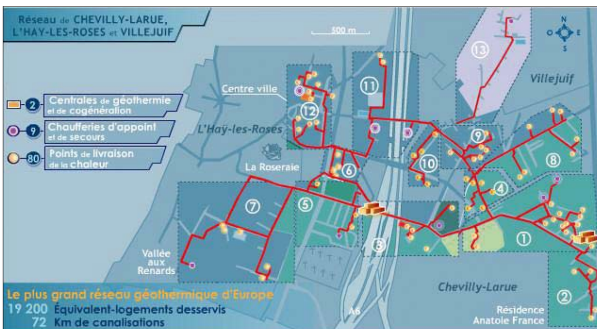
Extrait de plan du réseau de chaleur de Chevilly-Larue, L'Hay-les-Roses et Villejuif © SEMHACH.
